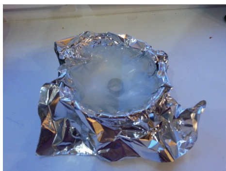
в) Процесс очистки серебряного изделия алюминиевой (пищевой) фольгой в содовом растворе
