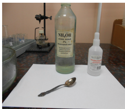
в) Процесс очистки серебряной ложки раствором аммиака (10%)
