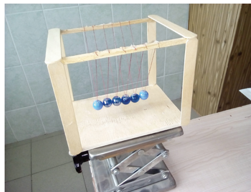
Рис. 3. Прибор для демонстрации закона сохранения импульса
