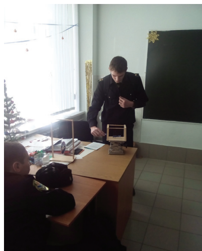
Рис. 4. Работа прибора для демонстрации закона сохранения импульса на учебных занятиях
