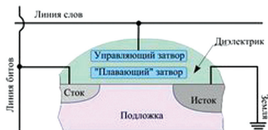
Рис. 1. Ячейка флэш – памяти на полевом транзисторе
