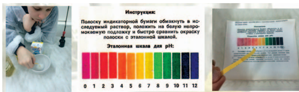
Рис. 7. Определение наличия примесей соды и мела в молоке в лабораторных условиях
