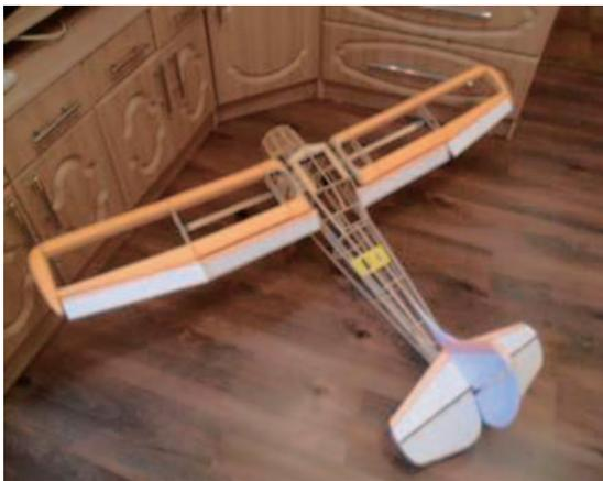
Рис. 3. Изготовление фюзеляжа из шпангоутов
