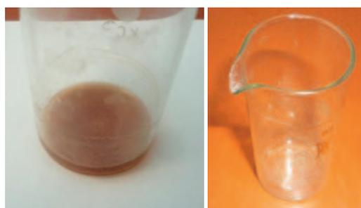
Вытяжка образца, содержащая ионы свинца  $Pb^{2+}$  раствор гидроксида калия
