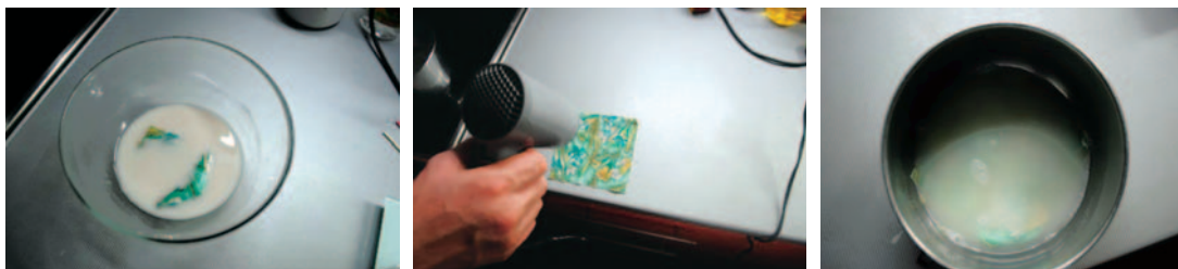
Вымачивание материала в растворе карбоната кальция, сушка, вымачивание в мыльном растворе
