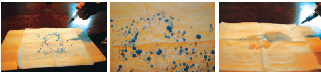
Опыт с салфеткой, сверху – обработанная наноспреем поверхность, снизу- необработанная
