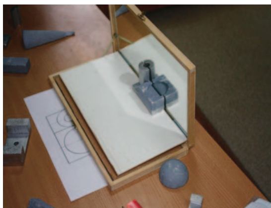
Рис.2. Процесс «конструирования» детали с использованием зеркальной столешницы с последующим выполнением чертежа
