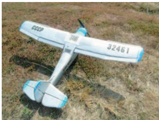
Рис. 5. Детализация беспилотника, модель-копии самолёта Як-12
