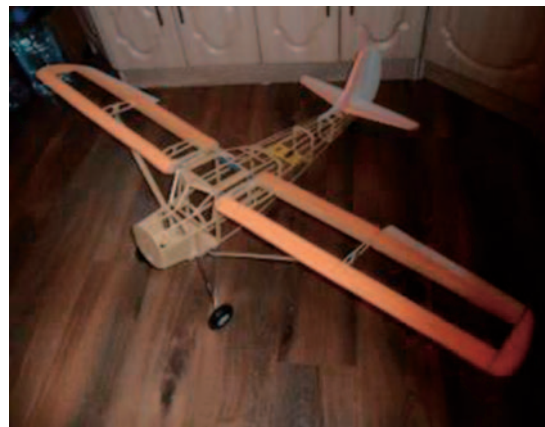
Рис. 2. Изготовление модели беспилотника с улучшенными аэродинамическими качествами крыла
