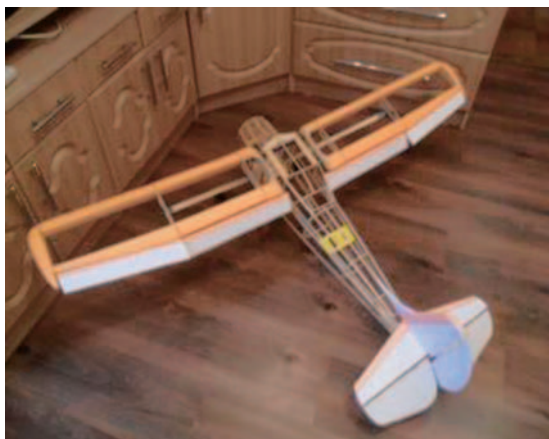
Рис. 3. Изготовление фюзеляжа из шпангоутов
