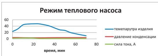
Рис. 5. Изменения температуры, силы тока, давления в зависимости от времени в режиме работы – нагрева и охлаждения
