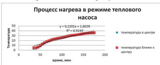
Рис. 6. Экспериментальные данные для процесса нагрева в режиме теплового насоса
