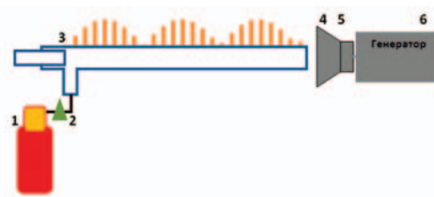
Рис. 1. Трубка Рубенса по демонстрации визуальных акустических стоячих волн. 1 – баллон с газом, 2 – клапан, 3 – металлическая трубка с отверстиями, 4 – мембрана, 5 – громкоговоритель, 6 – тон-генератор
