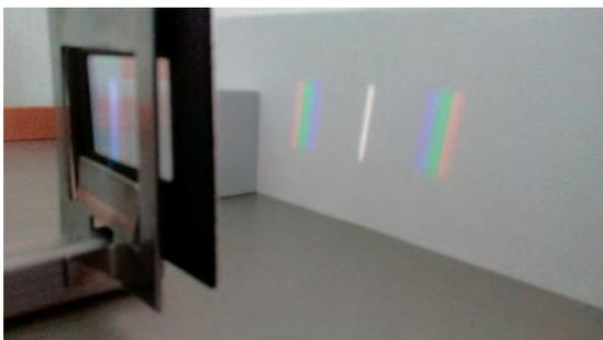
Рис. 2. Действительное изображение дифракционного спектра (при использовании щелевидного отверстия)
