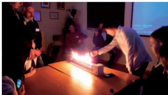
Рис. 4. Визуализация стоячей волны при помощи сконструированного индикатора давления
