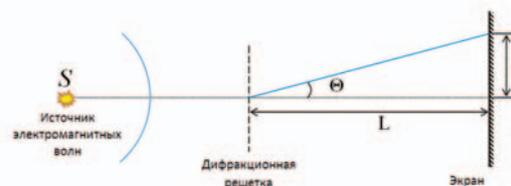
Рис. 3. Схема получения дифракционной картины
