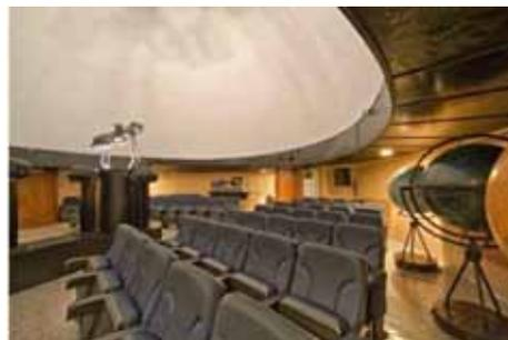
Рис. 4. Зал калужского планетария с последней моделью аппарата Skymaster ZKP4 с полнокупольной проекционной системой Spacegate фирмы «Карл Цейс», состоящей из пяти цифровых независимых проекторов
