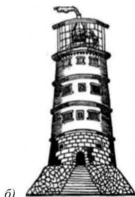
Рис. 7. Маяки: а – маяк – качалка (1560 г.); б – маяк с очагом, огражденный стеклянным фонарем
