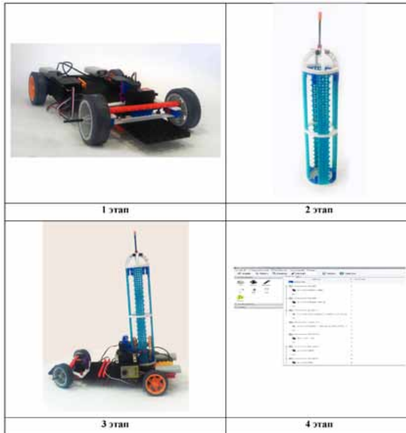
Рис. 4. Этапы сборки модели ракетоносителя «Восток»
