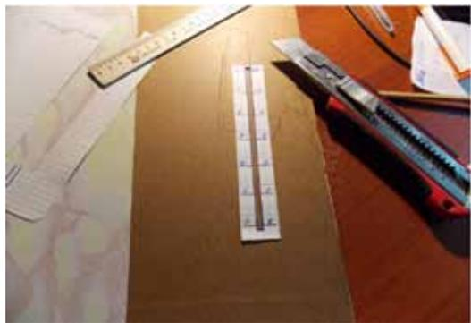
Рис. 3. Изготовление дождемера
