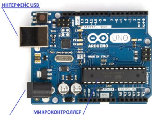
Рис. 1. Микроконтроллер Arduino UNO
