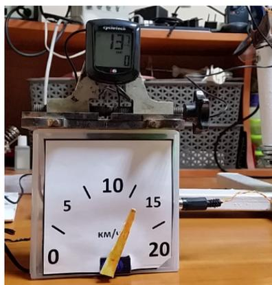
Рис. 12 Сравнение работы спидометра с эталоном
