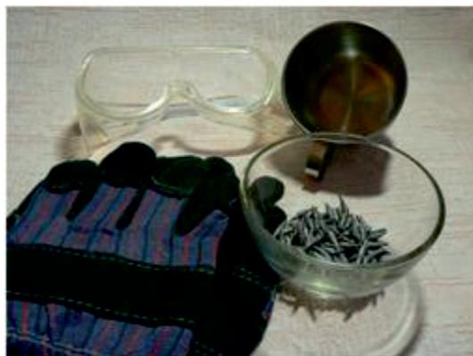
Гранулы висмута помещаем в нержавеющей чашке на конфорку газовой плиты. Через короткое время можем наблюдать начало плавления металла. Температура плавления висмута невелика – 271 °С.
