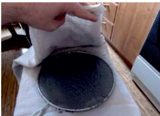
7. Проглаживаем горячим утюгом взвесь на сетке через полотенце. При этом получается, что, как и при настоящей переработке, мы используем давление – нажимаем утюгом, скрепляя волокна, и одновременно высушиваем формирующийся лист бумаги.
