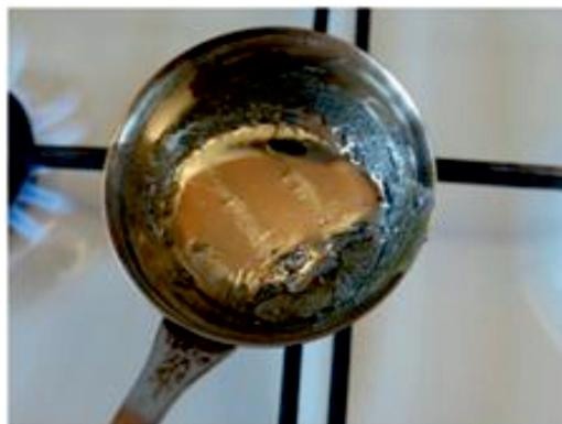
Для получения красивых кристаллов остывание образца должно протекать очень медленно. При остывании можно постучать по чашке с жидким висмутом, создавая центры кристаллизации.
