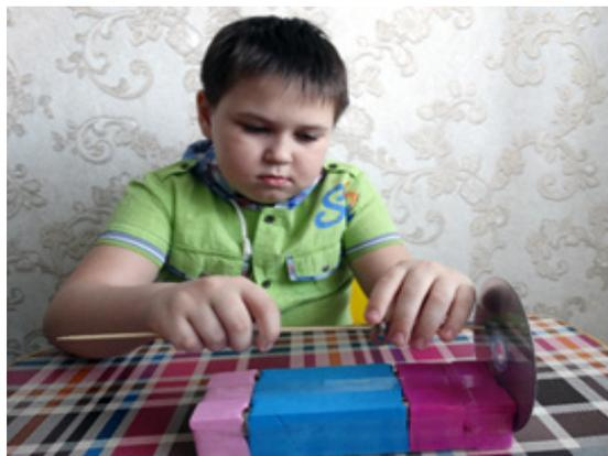
К своей конструкции я приклеил диск, на который будет упираться шпажка. Расположил магниты на шпажке над магнитами в конструкции. Магниты располагаются так, чтобы магниты в конструкции толкали магниты на шпажке в одну сторону, и шпажка упиралась в диск.
