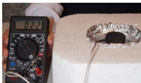
Наливаем жидкий азот и продолжаем измерять температуру поверхности сверхпроводника. Она начинает уменьшаться.
