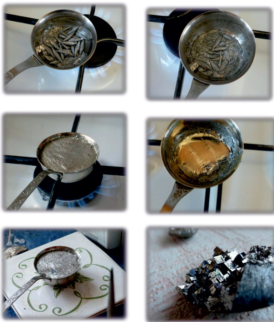
Способ получения кристаллов висмута (последовательность этапов)
