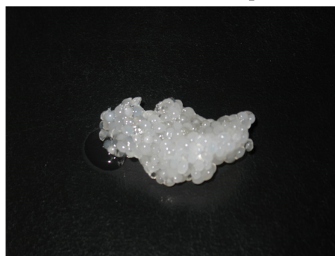
Гранулы после воздействия горячей воды
