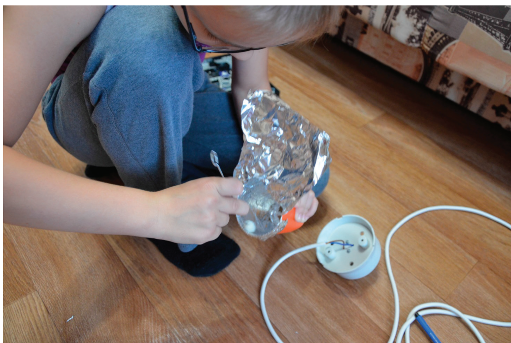
Рис. 5. Оклеивание рефлектора фольгой
