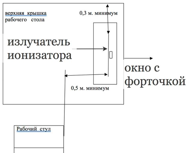
Рис. 1. Пример установки ионизатора на рабочем столе (вид сверху)
