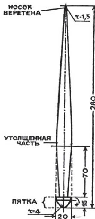
Рис. 1 Конструкция русского веретена [8]
