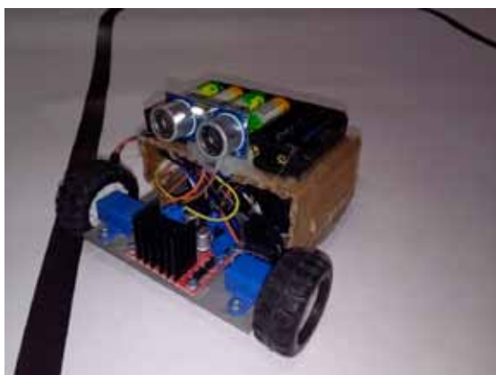
Модель парктроника на основе ARDUINO
