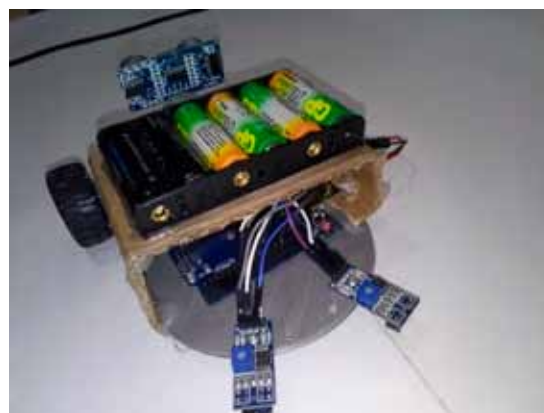
Установка ультразвукового датчика
