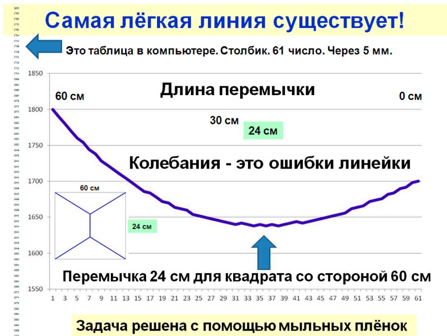
Рис. 3. Определение длины перемычки
