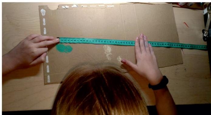
Рис. 13. Замер отклонения при падении сосулек
