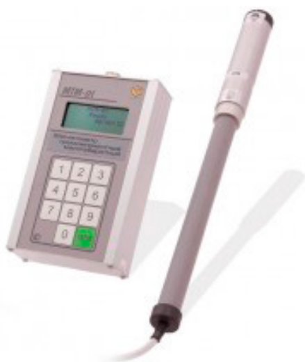
Измерение напряженности электрического поля производилось прибором СТ-01 «Универсальный измеритель напряженности и потенциала электростатического поля»
