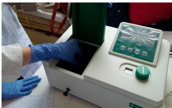
Фото 2. Фотометрирование серии градуировочных растворов на фосфат-анионы
