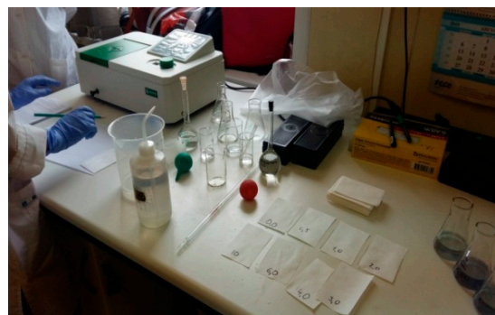
Фото 2. Фотометрирование серии градуировочных растворов на фосфат-анионы
