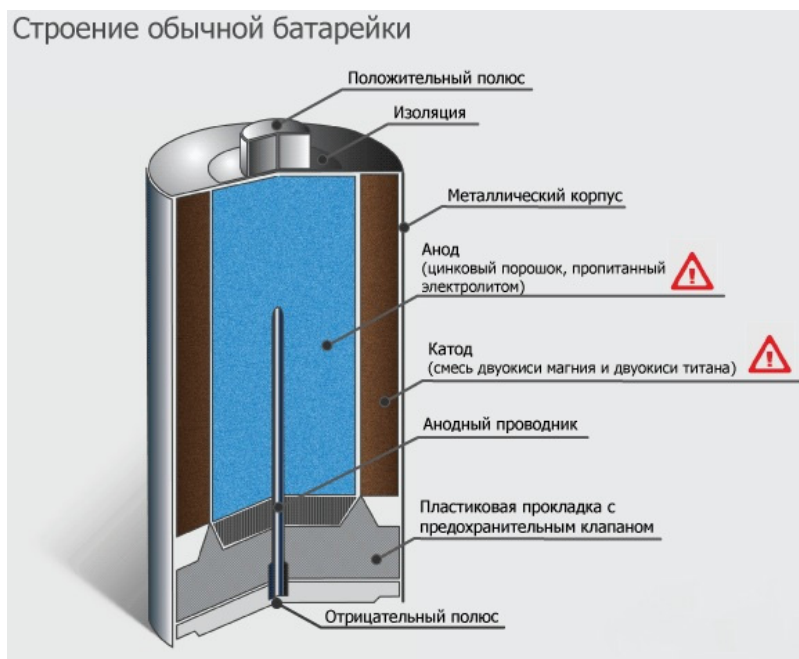
Рис. 2. Строение батареи постоянного тока
