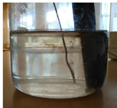
качестве электролита, использовали рапу. После включения источника питания электролиз начинается с бурного выделения газа на обоих электродах. На катоде начинает выделяться углекислый газ, появляется осадок в виде бархатистого черного слоя. Опадает с катода раствор, начинает окрашиваться в чёрный цвет.
