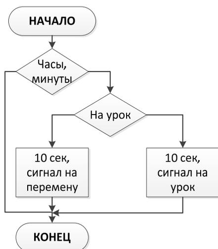
**Рисунок 8. Часть программы – так, как она выглядит на экране компьютера, визуальный язык.**
