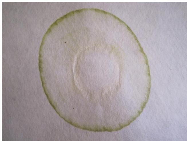
*Рис. 1. Разделения хлорофилла на фильтровальной бумаге*
