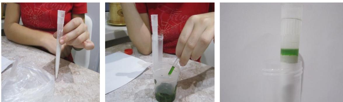
*Рис. 4. Разделение хлорофилла на колонке (крахмал)*
