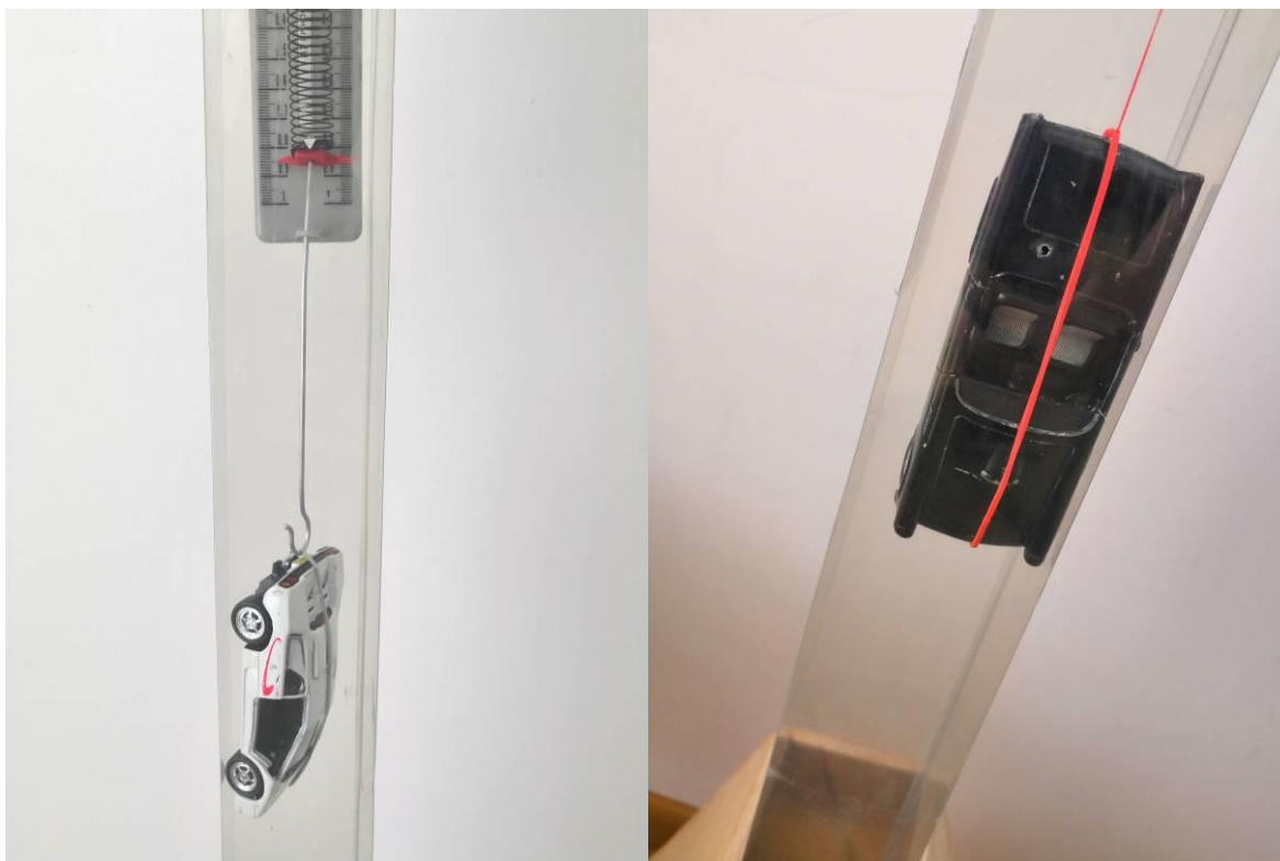
Рис.4. Измерение силы лобового сопротивления воздуха на модели автомобилей.
