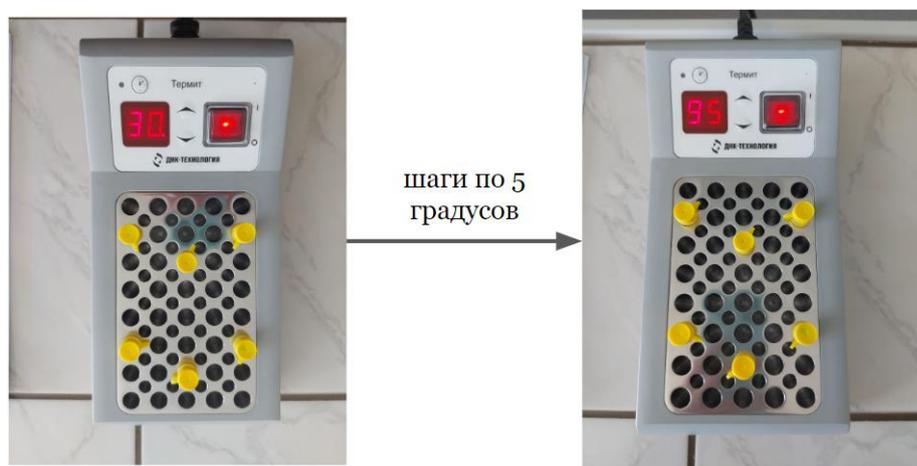
Рисунок 1. Измерение температур изменения цвета полученных пигментов с шагом в 5°C при помощи термостата.
