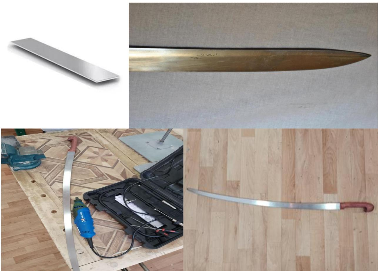
Рисунок 5. Изготовление клинка шашки
