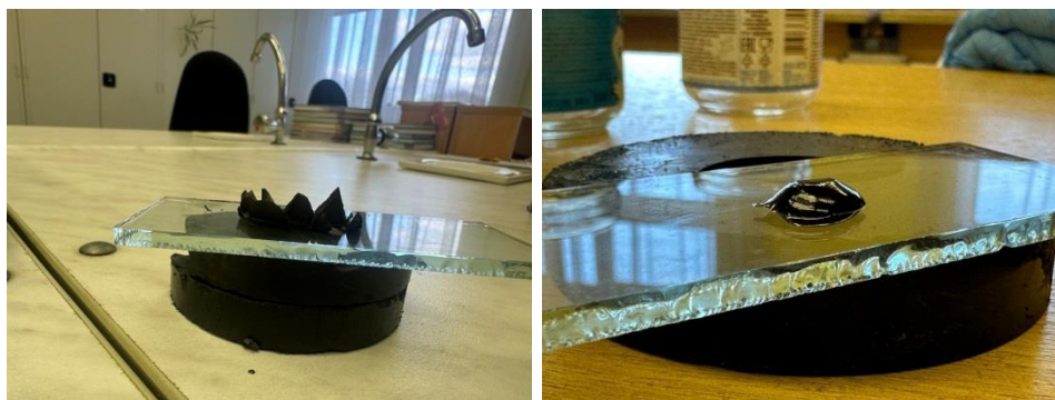
Рисунок 9 – Взаимодействие ферромагнитной жидкости с магнитным полем
