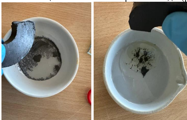
Рисунок 12 – Опыты по удалению с поверхности воды загрязнений из машинного масла
