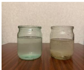
Рисунок 5 – Результат растворения стаканчиков в воде через 99 дней
