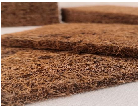
Рис. 7. Вид кокосовой прослойки для вермикомпостера.
