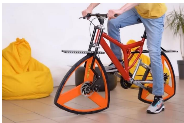
Рис.4 Пример колеса в виде треугольника Рело
